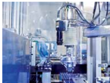
Sichtfenster-Entnahme mit integrierter Kamera zur Lageerkennung
