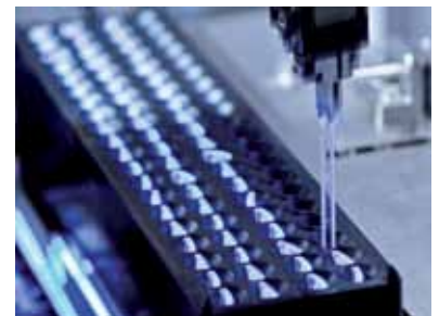
Sichtfenster-Entnahme mit integrierter Kamera zur Lageerkennung
